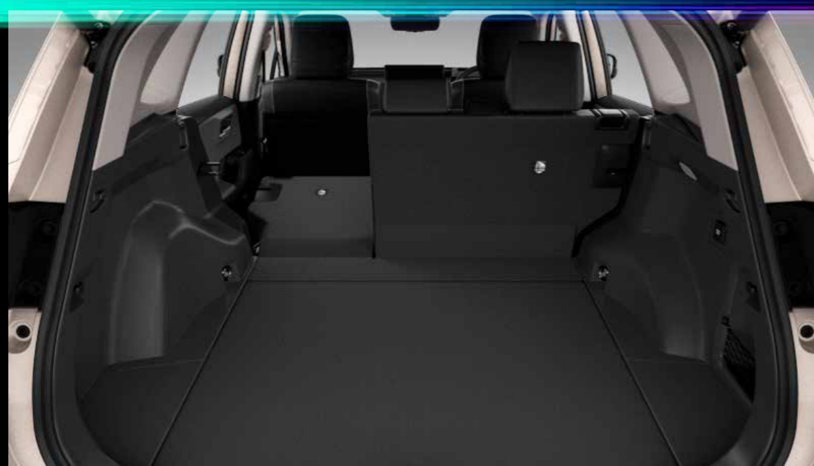
489/732 公升尾箱容量 (VDA 標準 - V213 / V215) 489/732 Litre Luggage Volume (VDA - V213 / V215)
